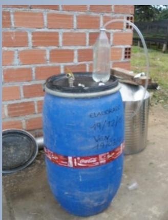
Por ultimo tapar el turril herméticamente, se debe dejar unos 20 cm. De espacio por debajo de la tapa para no obstruir el grifo y la salida del gas. Es importante colocar una manguera en el grifo para conducirlo a una botella de agua con la finalidad de que escape el gas, de esa forma garantizar la fermentación
