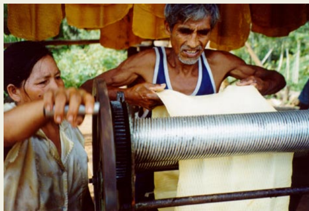
Proceso de laminado de caucho natural
