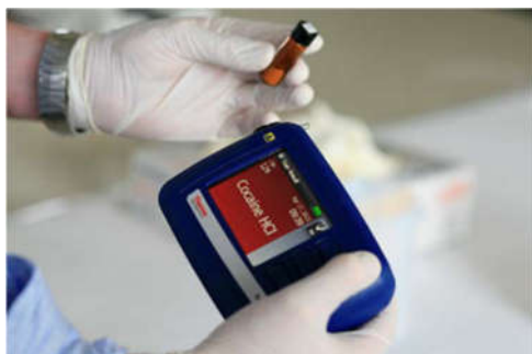
Рис. 1: Использование портативного устройства для спектроскопии комбинационного рассеяния в качестве инструмента предварительного отбора с проведением последующих подтверждающих анализов в лаборатории
